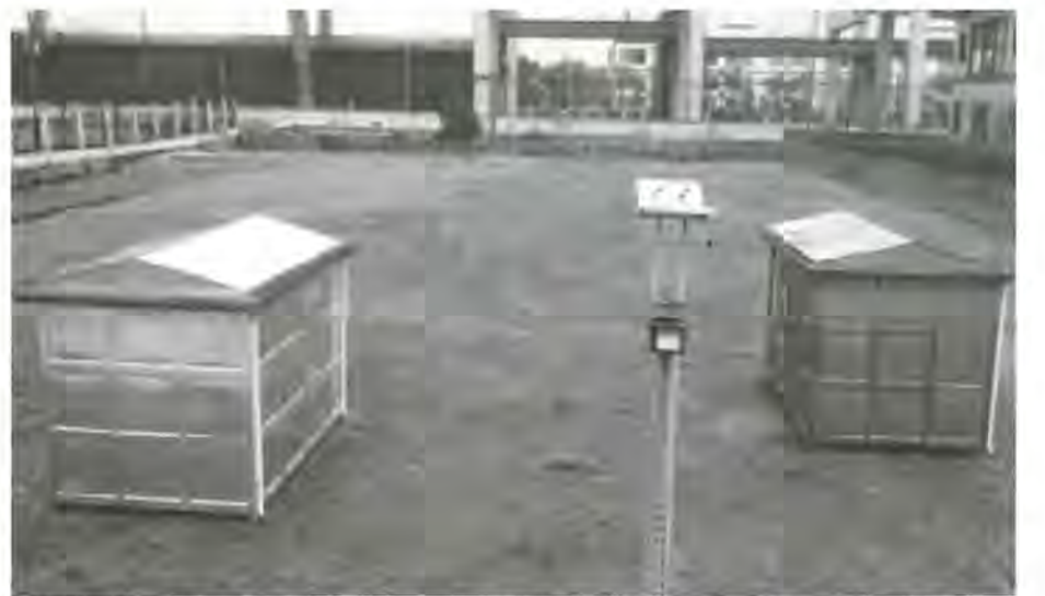
2018年7月末、中国寧波で行った実験の様子。ラディクールを施した小屋とそうでない小屋では29℃の温度差があった
